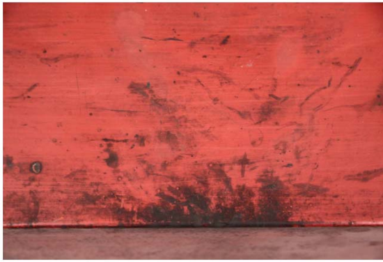
Fig. 6.: Black contamination on the drawer stand 6. ábra: Fekete szennyeződés a fiók alján
