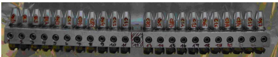
9. ábra: 22 db grafit targettel feltöltött mérési tár a MICADAS AMS ^{14}\text{C} méréshez
