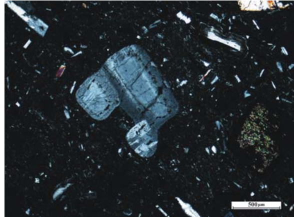
5a és 5b. ábra: Rezorbeálódott plagioklász, a szegélyén sok üvegzárvánnyal, valamint csaknem teljesen opacitosodott biotit (fekete), uralkodóan kőzetüvegből álló alanyanyagban. 34. sz. malomkő; Andezit1 típus, a) 1N, b) +N.
