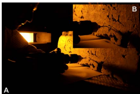
1. ábra: Mintavétel alacsony fordulatszámú fűró és speciális fűrófejek segítségével, kis nyomású Na lámpa fénye mellett
