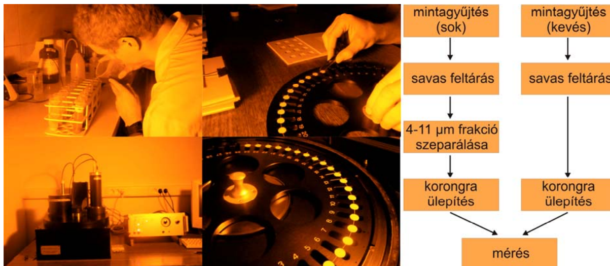
3. ábra: Laboratóriumi munka, a lumineszcens mérésekre szolgáló RISØ típusú műszer, valamint a feltárások folyamatábrája
