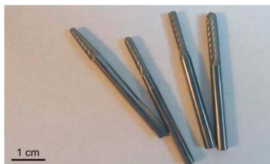
2. ábra: A mintavételhez használt nagy keménységű wolfrám-karbid fűró- és marófejek (balról a második és harmadik \varnothing 2,5 mm, balról a negyedik \varnothing 2,8 mm)
