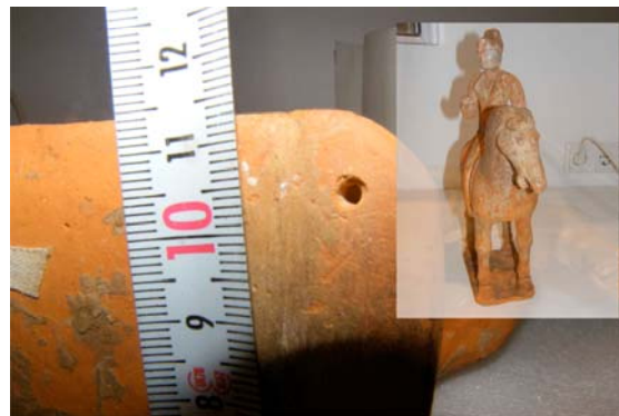
6. ábra: Mintavételi furat eredetiség vizsgálathoz. A furat külső része nagyobb ( \varnothing 2,8 \text{ mm} ), belső része kisebb ( \varnothing 2,5 \text{ mm} ) átmérőjű fúrófejjel lett kialakítva. A mintát a tárgy eldugott, nagyobb anyagvastagságot biztosító részéről gyűjtöttük.
