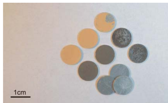
4. ábra: Előkészített mintahordozó alumínium korongok. Bal oldalon jó fedettségű korongok, jobb oldalon nem megfelelő fedettségű korongok, alul tiszta korongok minta nélkül
