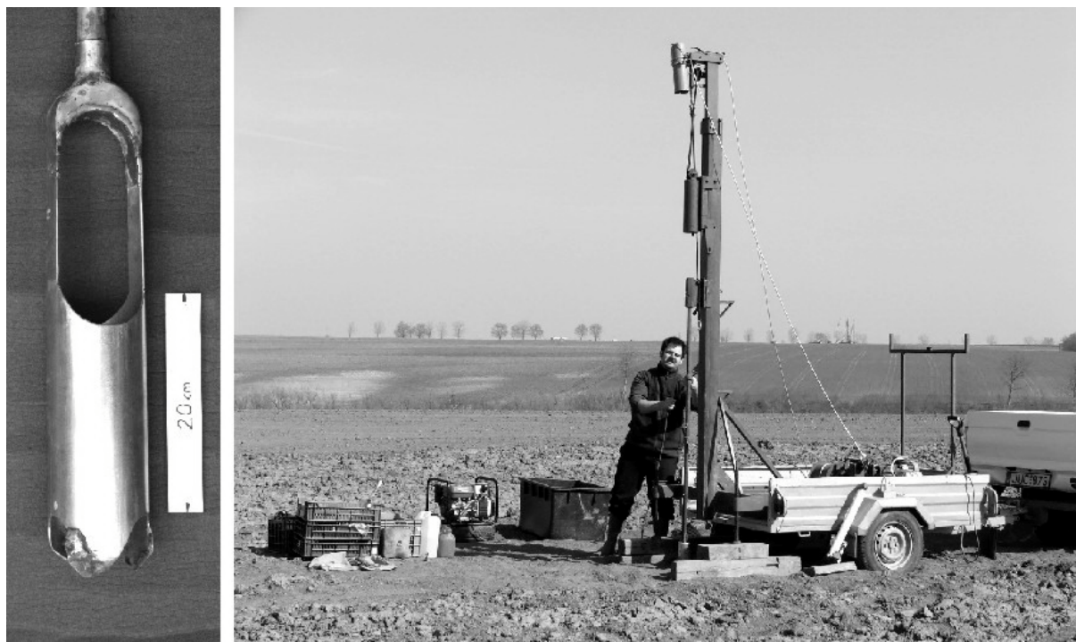
3. ábra: Kézi mintavevő feje és a bolygatatlan mintavételre alkalmas berendezés
