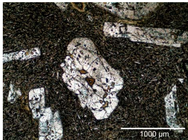
13. ábra: Petrográfiai-mikroszkópos fotó (1N): szöveti kép plagioklász (pl)-fenokristályokkal. (AV-28-as minta – Jobbágyi, Mátra)
