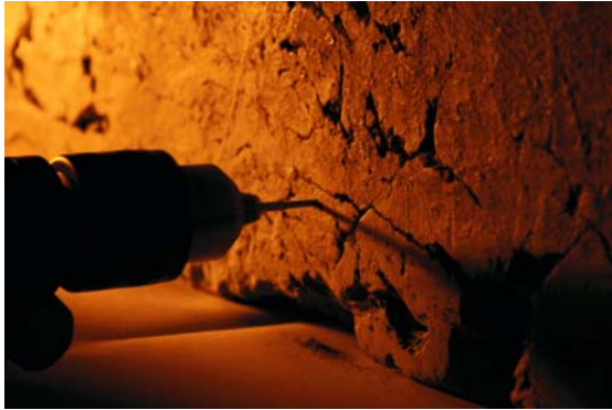
4. ábra Mintagyűjtés volfrám-karbid fűrófejjel, kis nyomású Na fényforrás szűrt fénye mellett
