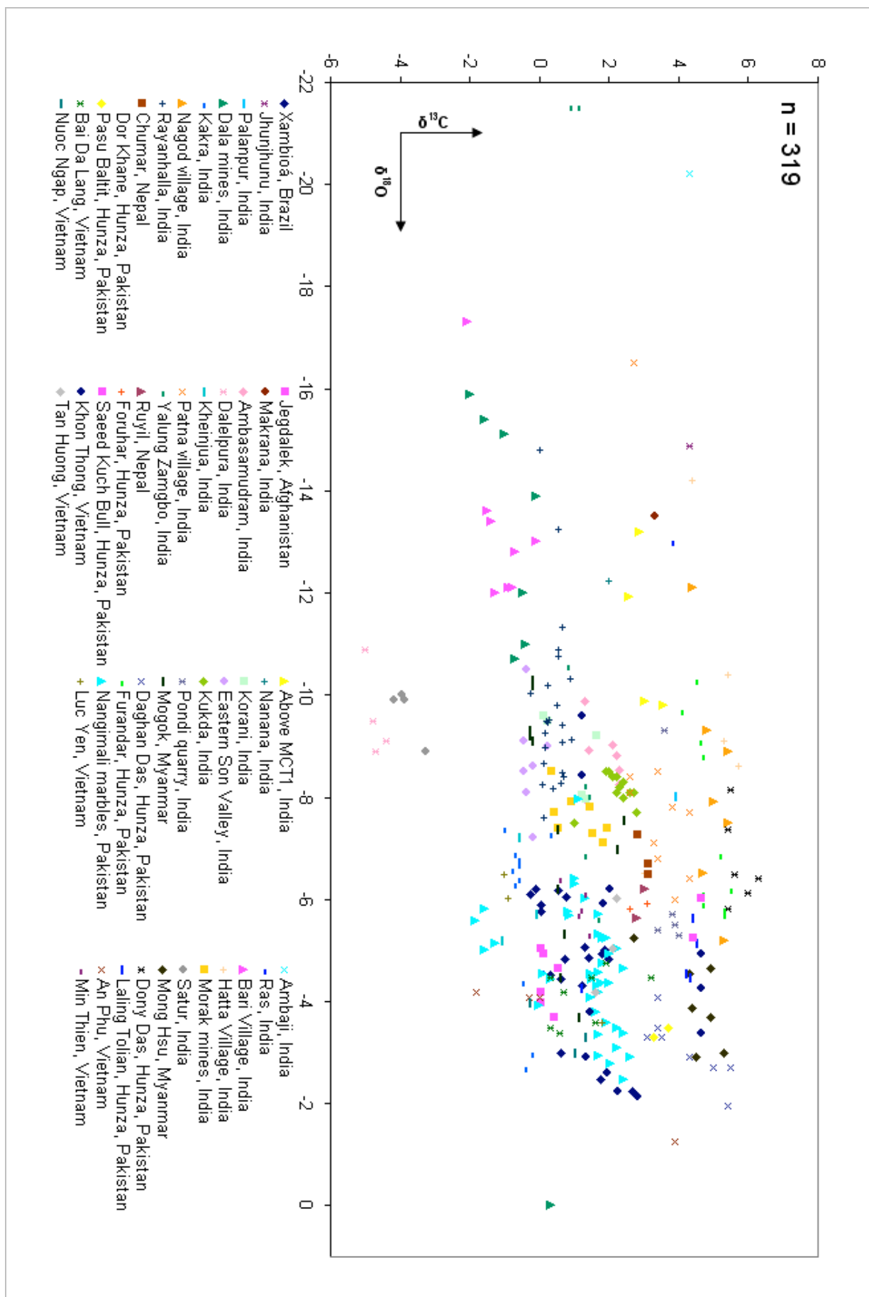
2.d ábra: Az indiai szubkontinensről illetve Indokínából(d) származó márványok stabilizótóp-eloszlása (Santosh et al. 1996, Pecher et al. 2002, Maheshwari et al. 2002, Liu et al. 2006 és Garnier et al. 2008 alapján).
