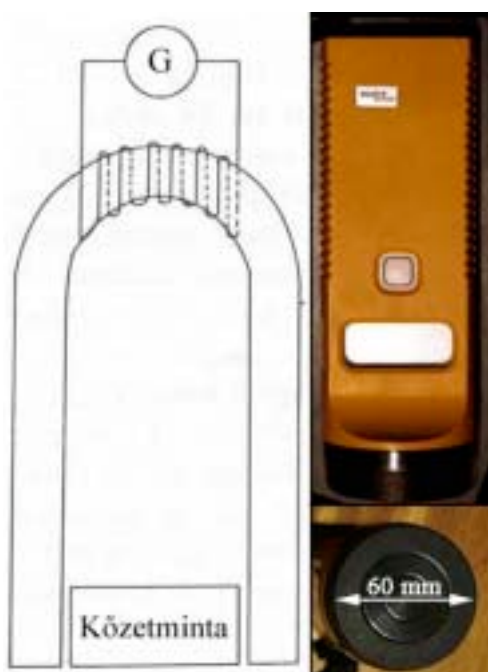
2. ábra: Kappameter KT-5 mágneses szuszeptibilitás mérő műszer és működési elve
