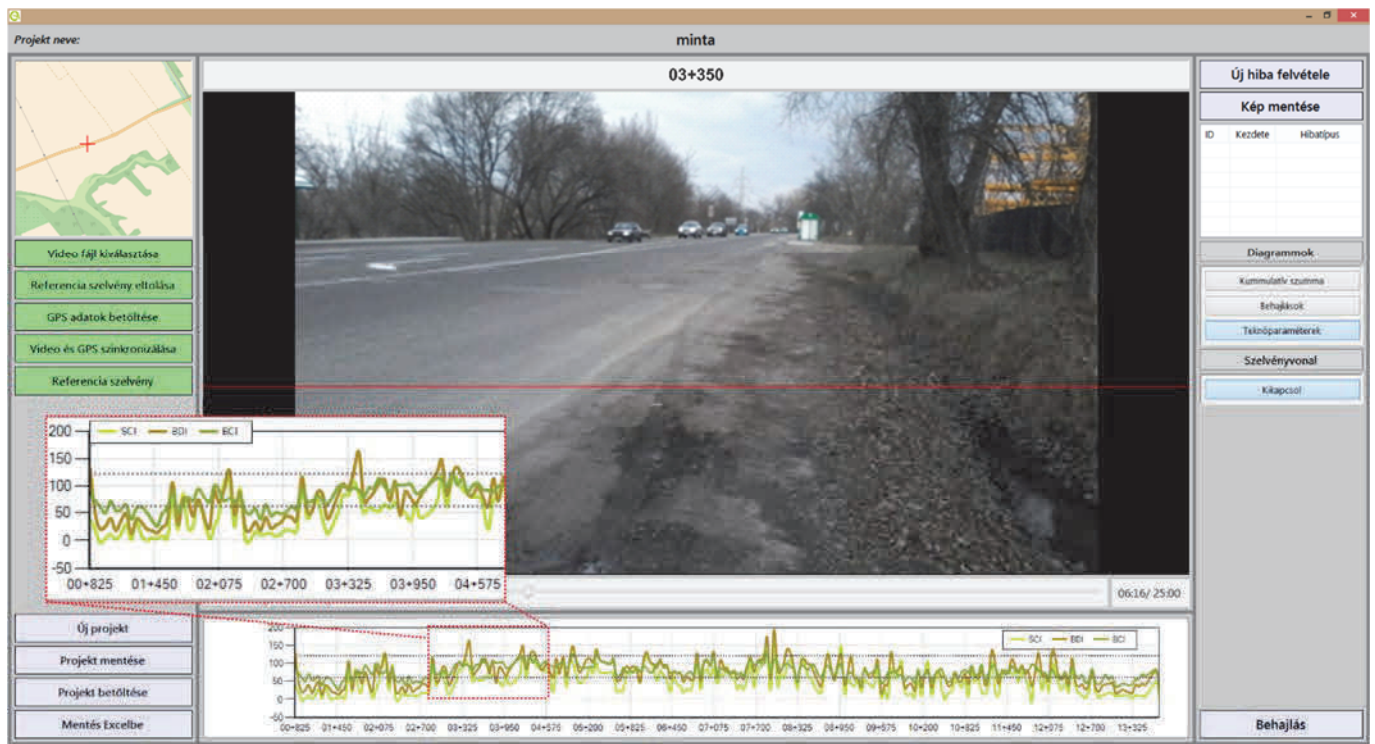
8. Ábra. Pangó víz a csapadékvíz-elvezető rendszerben, átázott földű diagnosztizálása
