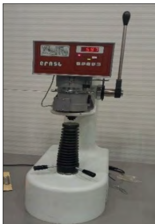
5. ábra. Rockwell C-keménységmérés
