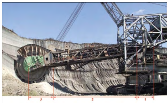
7. ábra. A marótárcsás kotrógépek teherhordó szerkezete
