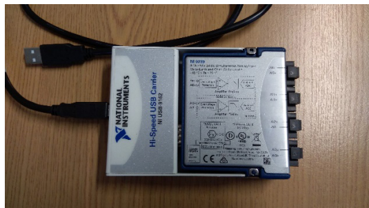
3. ábra. NI 9239 analóg-digitál (AD) modul az NI USB-9162 típusú USB-adapterrel
