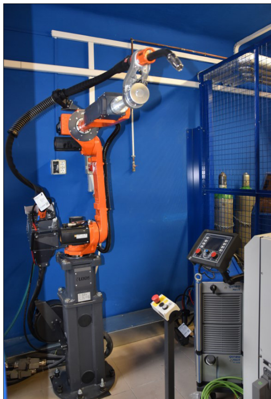
1. ábra. A telepített robotrendszer részlete a hegesztőrobottal, az áramforrással
