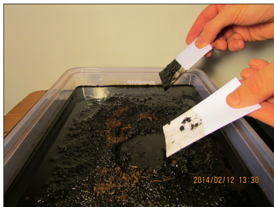
3. ábra. Abszorpciós „spill-sorb” anyag tesztelése (az olajfelületre szórt anyag kivágása után nem marad szennyeződés) [3]
