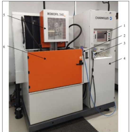
3. ábra. Charmilles FI240 típusú szikraforgácsoló gép 1. kezelő és megfigyelő terület, 2. levegőfűtőka, 3. huzalfej-tájoló egység, 4. generátortörté, 5. huzaladagoló berendezés, 6. munkatér
