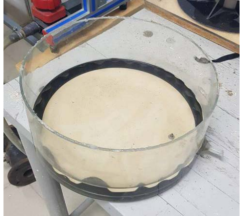
11. ábra. A nagyobb HAES lap áztatás (telítés) közben.
