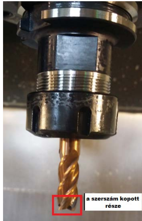
4. ábra. A maró kopott része a nem megfelelő stratégia és megmunkálási sebességek használatának következtében
