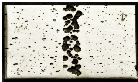
1. ábra. Hozaganyag nélküli hegesztett kötés korróziója
