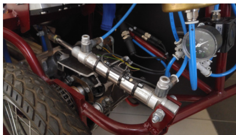
6. ábra. A beépített, váltást végző munkahenger
