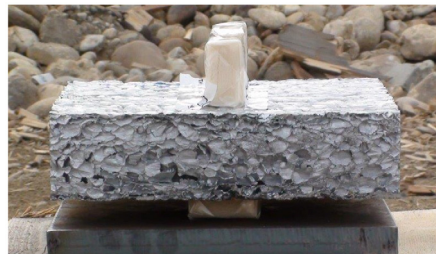
3. ábra. Zárt cellás alumínium hab [1]
