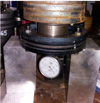
5. ábra. A tárcsarugók állandójának meghatározása
