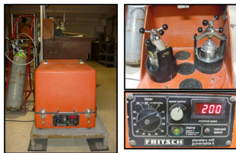
9. ábra. Az őrlésnél használt golyósmalom
