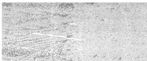
15. ábra. Átmenet a nem kevert (oszlopos) és kevert (ekvixiális) rész között (TMF)
