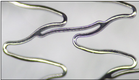
2. ábra. A sztent felülete a vizsgálatok előtt
