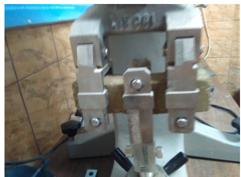
3. ábra. Hajlító szakítószilárdsági teszt
