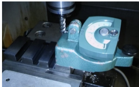
3. ábra. A Mazak gép és a szerszám együttes hibájának bemérése finomtapintóval
