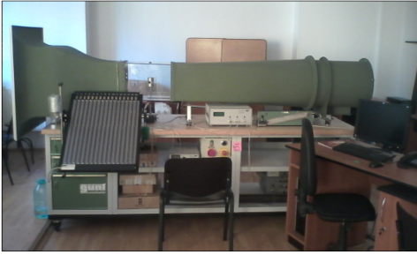
4. ábra. Kutatásra és oktatásra használt kisméretű szélcsatorna a tanszékünk szerkezeti laborjában
