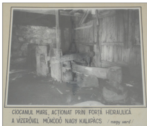
4. ábra. A vízerővel működő nagykalapács
