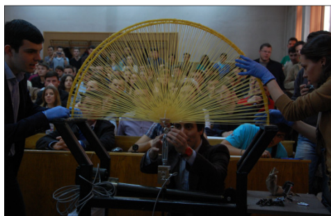
6. ábra. Egy teszthíd töréspróbája a 2014-es óbudai RECCS-re való selejtezőkön
