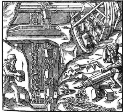
2. ábra. Taposókerekű kannás vízemelő gép (A – taposókerek, B – tengely, C – kettős lánc, D – a kettős lánc egyik szeme, E – kannák, F – egyszerű kapocs, G – háromszor hajlított kapocs) [2]. Bányavízemelő meghajtása taposókerekkel, Agricola könyvéből [2]
