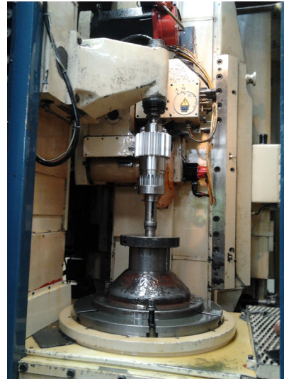
4. ábra. A FANUC vezérléssel felújított fog-köszörűgép munkatere
