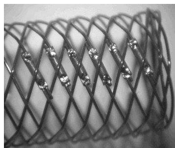
6. ábra. Huzalvégek tompakötése a mandzsetta lézersugaras áthegesztésével; az eredeti képek forrása: [5]
