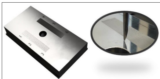
4. ábra. A kontúrmérés vizsgálati pontjainak elhelyezkedése a szerszámbetét felületén [3]
