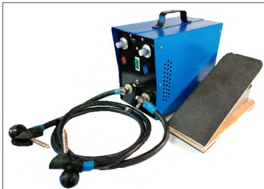
3. ábra. Az elkészült ponthegeztő a munkakábelekkel és elektródákkal, valamint a lábkapcsolóval
