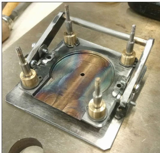
4. ábra. A mintatartó tálca és az emelőmechanizmus a vázszerkezetre építve
