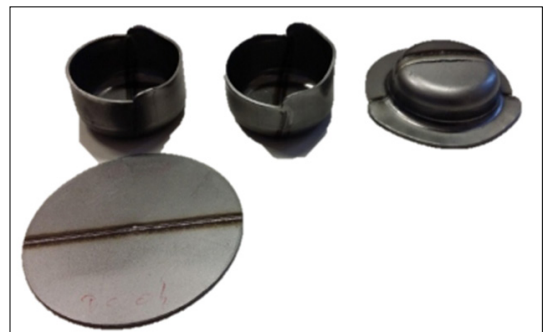
13. ábra. Hegesztett terítékekből mélyhúzott csészék fényképfelvétele
