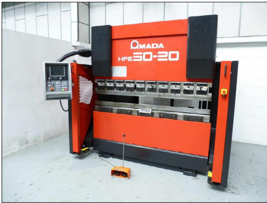
2. ábra. AMADA HFE 50-20 típusú, CNC-vezérlésű élhajlító gép.
