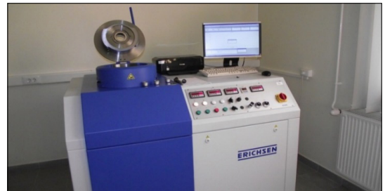
7. ábra. Univerzális lemezvizsgáló gép
