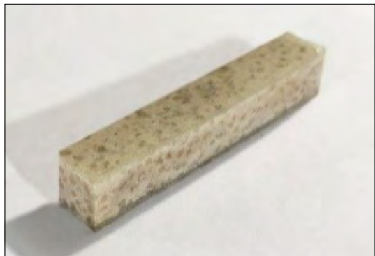
6. ábra. Az üvegszál szövettel és epoxigyantával laminált próbatest képe
