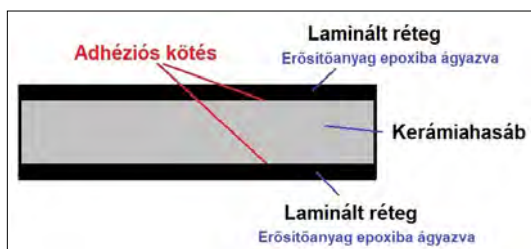
4. ábra. A szendvicspanel felépítése
