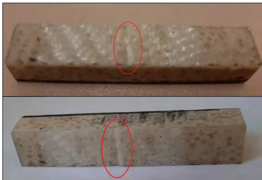
9. ábra. Üvegszövettel laminált próbatest vizsgálat után, a kalapács nyoma jelölve
