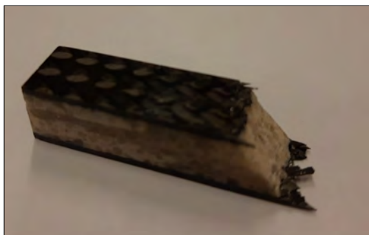
13. ábra. Szénszál szövettel és epoxigyantával laminált próbatest
