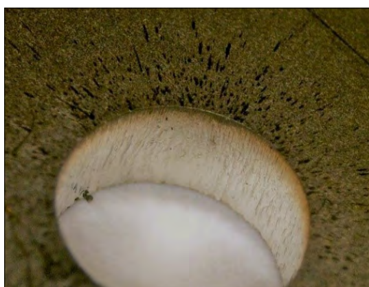
6. ábra. Fröcskölés a koronglézerrel vágott furat pereménél ( \phi 6,2 furat)
