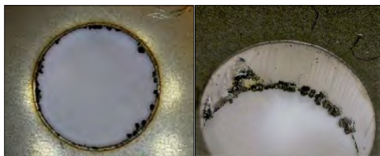
1. ábra. Visszatapadó vas-oxidok CO 2 -lézerral vágva (φ 6,2 furat)
