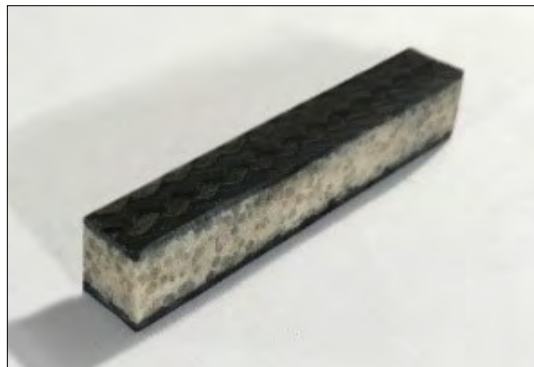
7. ábra. A szénszál szövettel és epoxigyantával laminált próbatest
