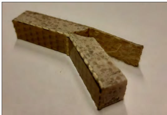
14. ábra. Aramidiszövettel és epoxigyantával laminált próbatest a törés után
