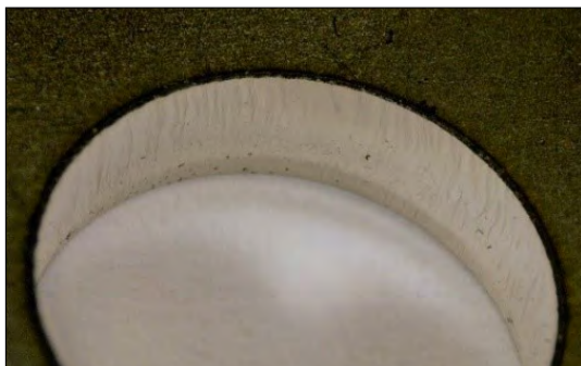
4. ábra. Koronglézerral készült furat (φ 13,6 furat)
