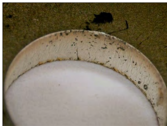
7. ábra. Koronglézerrel készült furat – a fókusz távolság eltért a középvonaltól ( \phi 13,6 furat)
