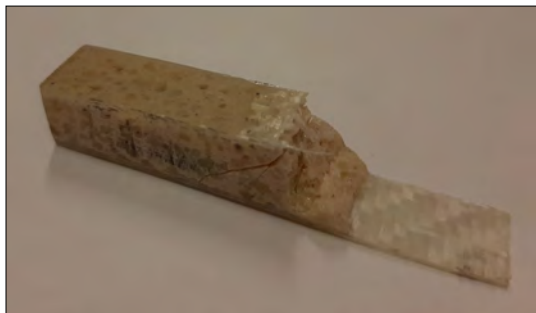
12. ábra. Üvegszövettel és epoxigyantával laminált próbatest
