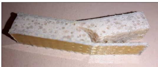
11. ábra. Az aramidiszál szövettel és epoxival laminált próbatest a törés után
