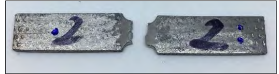
11. ábra. A hegesztett, módosított próbatest elszakítva
