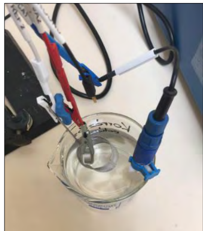
1. ábra. Korróziós mérési elrendezés
