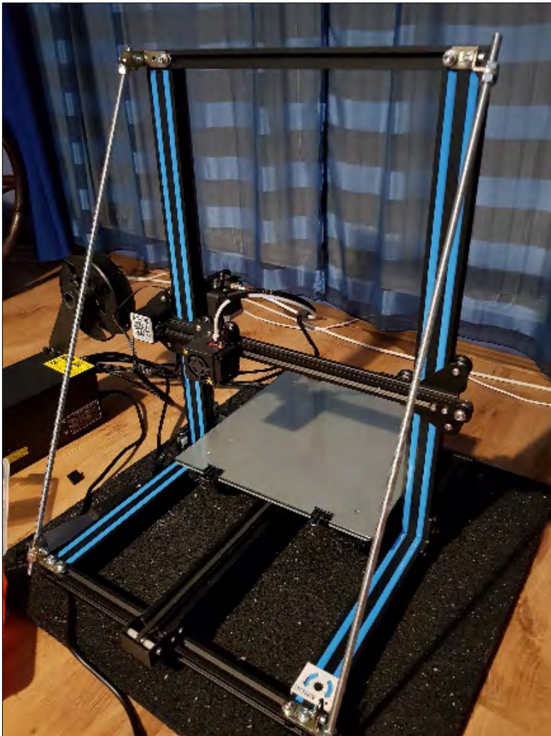
1. ábra. A próbatetek gyártásához használt 3D nyomtató, a Creality Cr 10
