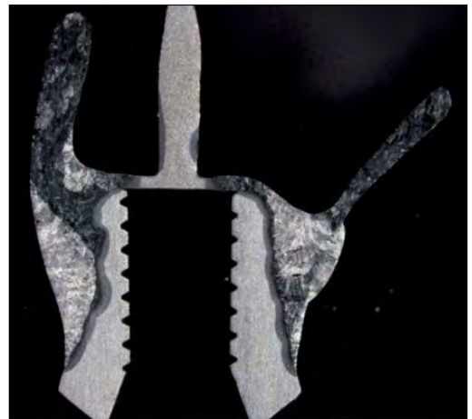
21. ábra. A hegesztett titánszerkezet metszeti képei (optikai mikroszkóppal különböző megvilágítással, kontrasztokkal készített képek)
