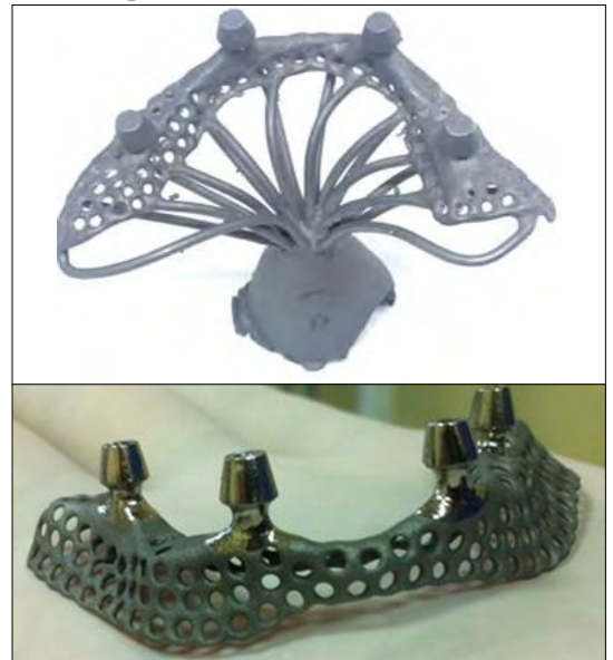
1. ábra. Egybeöntött titán fémszerkezet nyers öntvénye és a beültetésre kész implantátum
