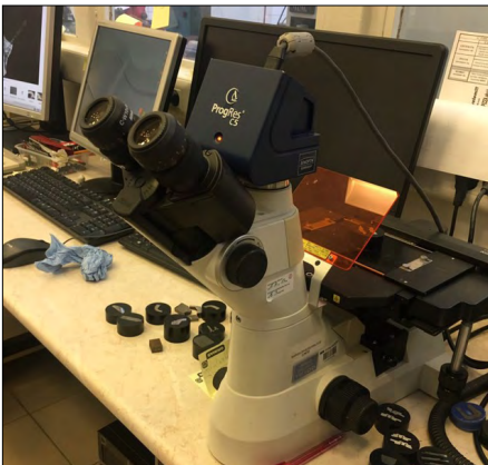
20. ábra. A csiszolásvizsgálathoz használt mikroszkóp
