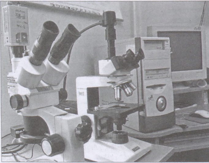
1. ábra. Fénymikroszkópok – számítógéppel összekötött digitális mikrofotó-berendezéssel szerelve (SVHS Flex Cam., PE. Georgikon Kar, Keszthely)
