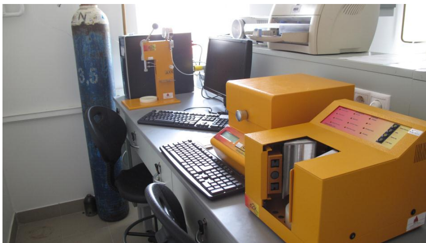
4. ábra: CAL2K E2K típusú száraz köpenyes izotermikus bomba kaloriméter (Forrás: Saját szerkesztés)
