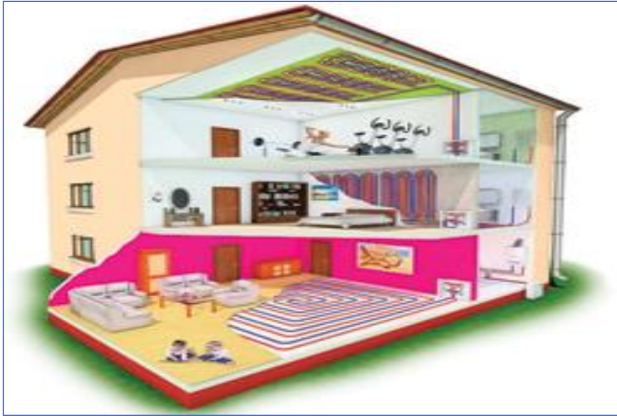
6. ábra: Kombinált padló, fal és mennyezetfűtés Forrás: http://ezermester.hu
