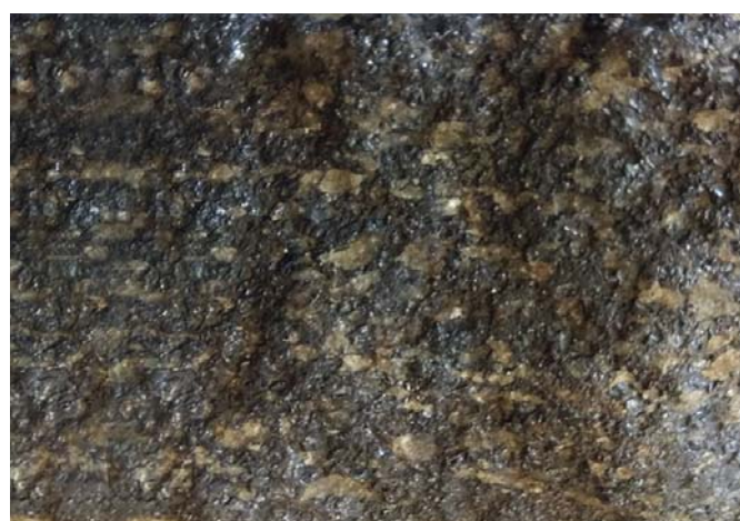
4. ábra. Szemcsés, tömeges kifejlődésű, acélszürke magnetitkristályok alkotta oxidos vasérc (Kola-félsziget) sárgásbarna apatittal (Ca-foszfát változat) az SZTE Ásványtani, Geokémiai és Kőzettani Tanszék gyakorlógyűjteményéből (képszélesség: 6 cm)
