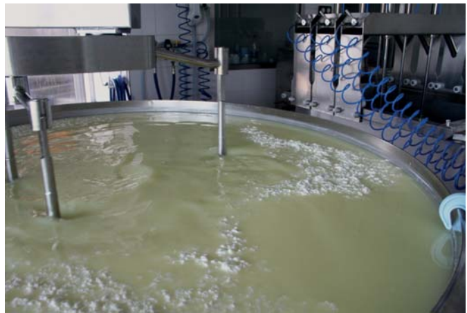
2. ábra. Az alvadék felvágása (balra) és az ennek hatására bekövetkező savóleadás folyamata
