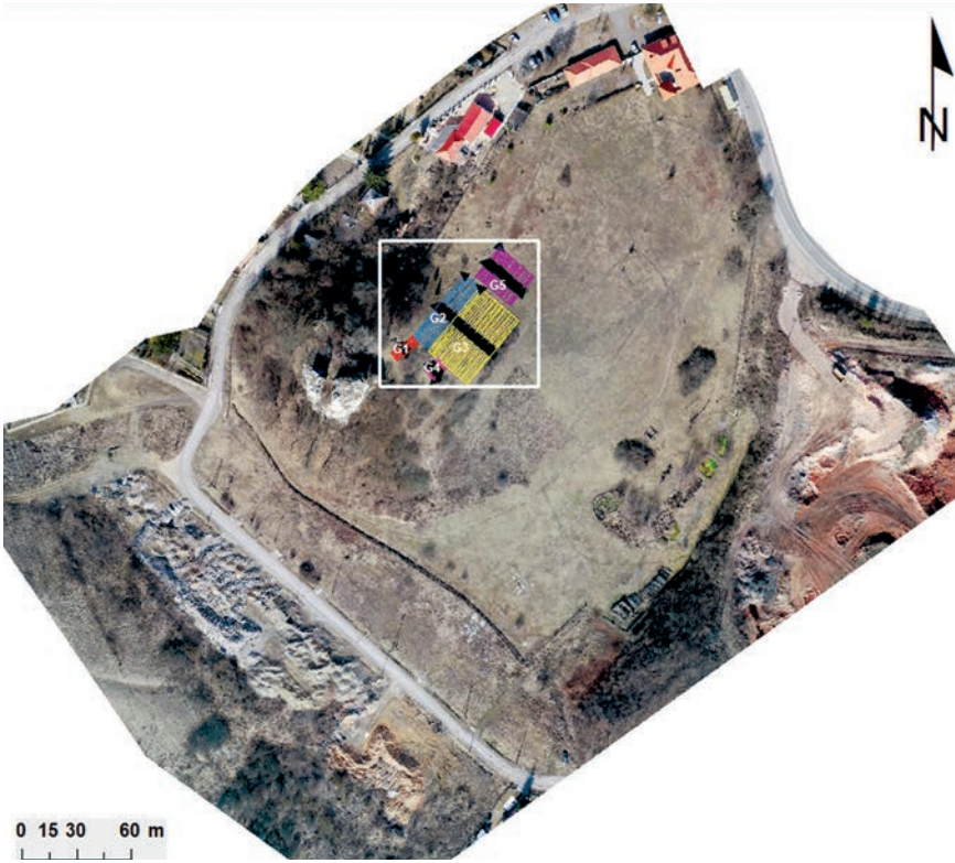
9. kép: Talajradaros felmérés a vár előterében (OSL Kft. ©)
