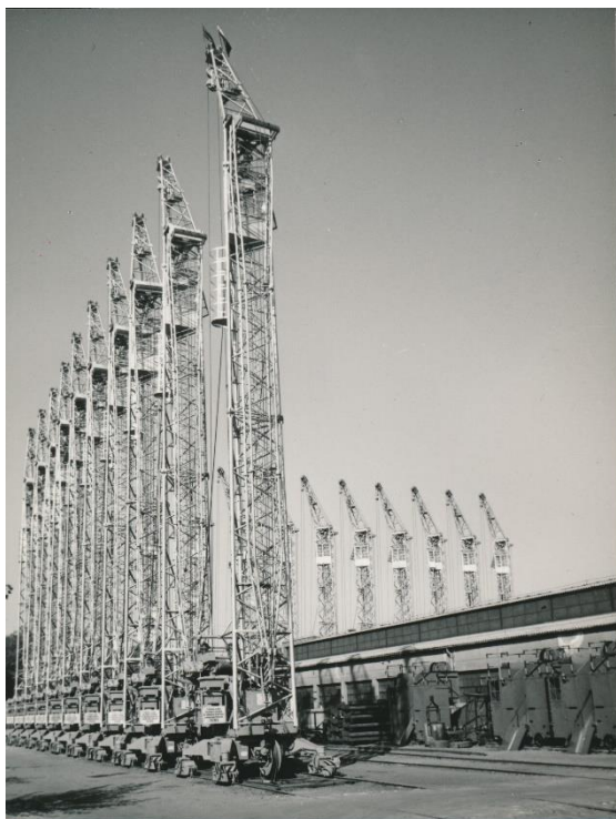
6. számú kép. 20 Mpm-es (megapond-méteres) önszerelő toronydaruk a gyár udvarán az 1960-as években (Fotó: Tomory Lajos Múzeum / Horvai Ferenc)
