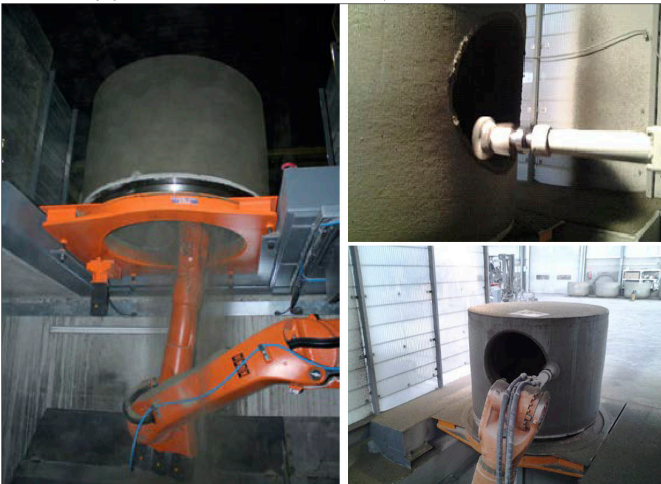
9-11. ábrák: Aknaalj folyásfenék részének és csőcsatlakozásainak 3D marása (fotók: Spránitz)
