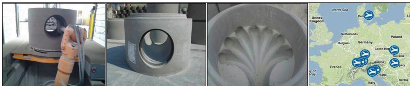
5-8. ábra: Az előregyártásban 2009-től terjed a 3D betonmarás (fotók: Spránitz)
