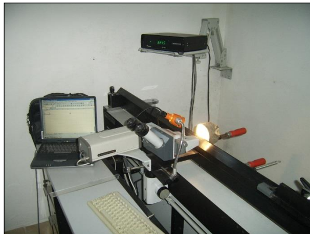
1. ábra. DIGITALPOSITIONIMETER Type 2 típusú évgy r analizátor berendezés az ERTI Püspökladányi Kísérleti Állomásán.
