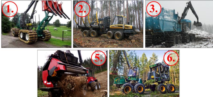
4. ábra. Forvarderek alkalmazása vágástéri melléktermék kezelésében
