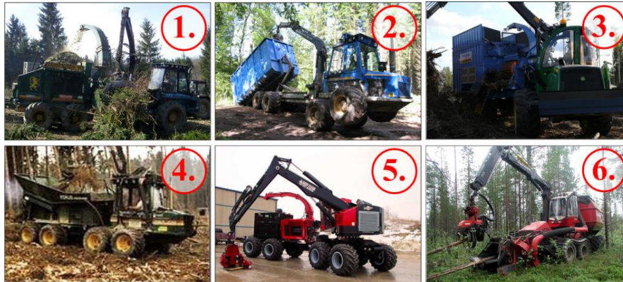
3. ábra. Forwarderek alkalmazása aprításban
