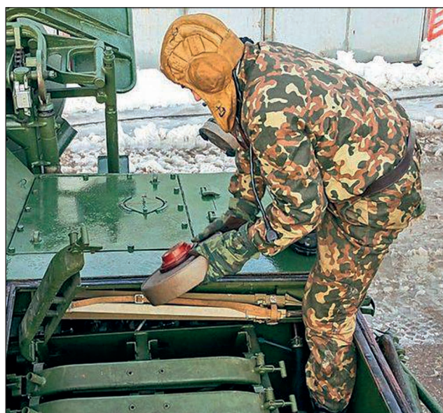
5. ábra. Az aknatároló rekeszek kézi feltöltése [6]
