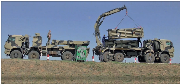
7. ábra. TPK konténerek átmálházása a szállító-rakodóról az aknásító járműre [8]
