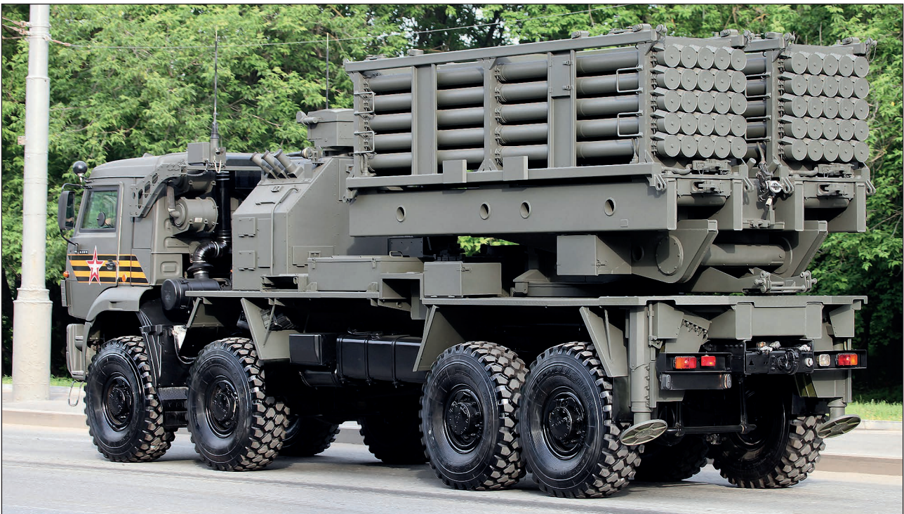
8. ábra. A vetőcsövek elhelyezkedése a konténerekben [9]
