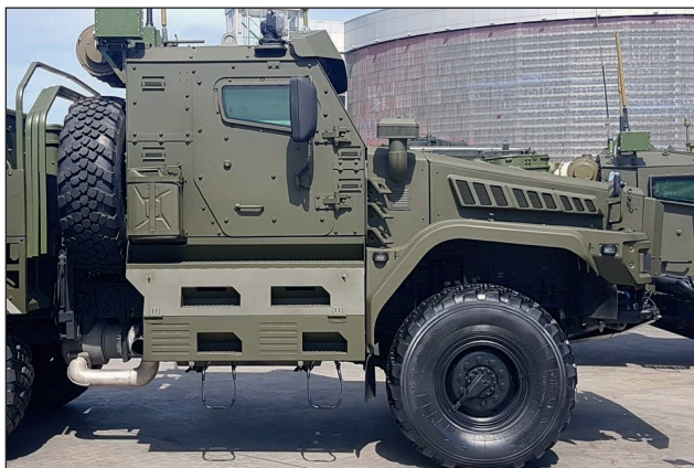
15. ábra. Az UMZ-K aknaszóró páncélozott vezetőfülkéje [11]
