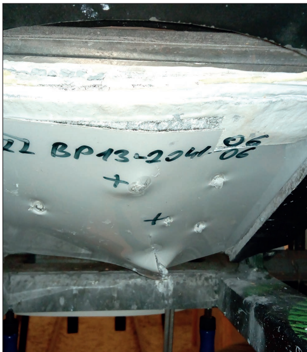
6. ábra. Egy, a vizsgálatok során elvetett gurulatmentesítő burkolat (Fotó: Bimbó István)
