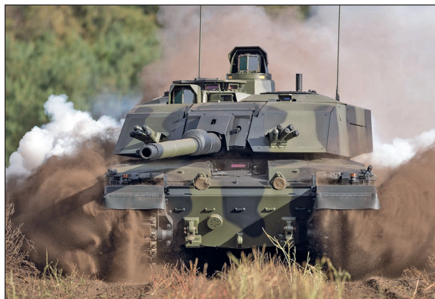
4. ábra. A Challenger Mk3. Legkönnyebben a parancsnok és az irányzó új, méretes éjjel-nappali optikai figyelőműszere alapján lehet megkülönböztetni az Mk2-estől [13]
