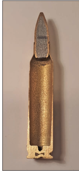
6. ábra. Az 5,56×45 mm-es SS109 normál lőszer felépítésének metszete: hüvely és lövedék (Fotó: Éles Péter)
