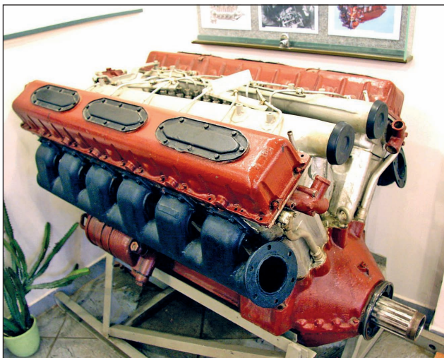
5. ábra. V2 típusú harckocsimotor (1936) (Fotó: Lányi Aladár)
