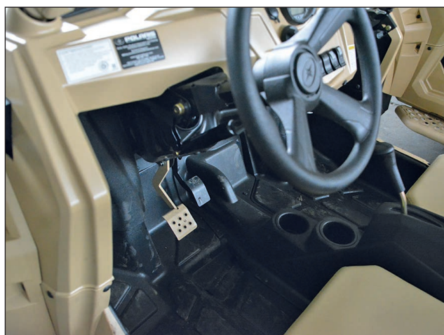
9. ábra. A Polaris MRZR 4 műszerfala. A jármű kialakítása lehetővé teszi a nagynyomású fecskendővel történő tisztítását (Fotó: Kelecsényi István)
