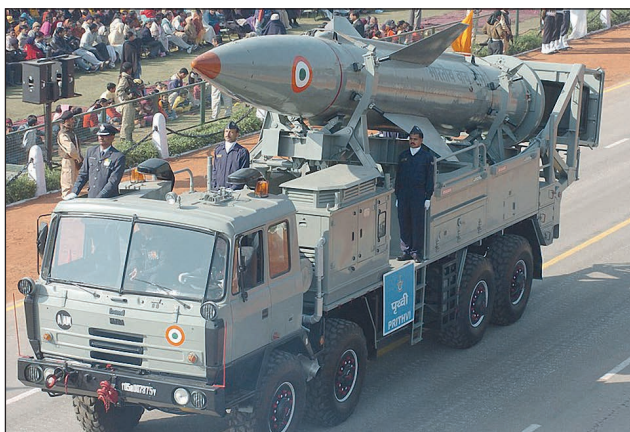
5. ábra. A rövid hatótávolságú Prithvi-I-est nagy terepjáró képességű, cseh gyártmányú Tatra 815-ösökre telepítették [24]
