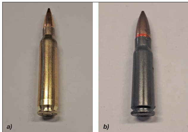
4. ábra. Az 5,56×45 mm-es SS109 löszert (balról) és a 7,62×39 mm-es 43M PSZ löszert (jobbról) (Fotók: Éles Péter)
