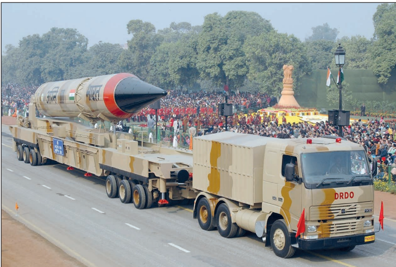
8. ábra. Az Agni rakétszaladot szállító és indító, közúti nehéztéler szerelvények, még a terepjáró Tatra tehergépkocsi által hordozzott Prithvi-komplexumoknál is kevesebb mobilitással, és ezáltal védelemmel rendelkeznek. A képen egy Agni-III típusú rakéta hordozóeszközön [11]
