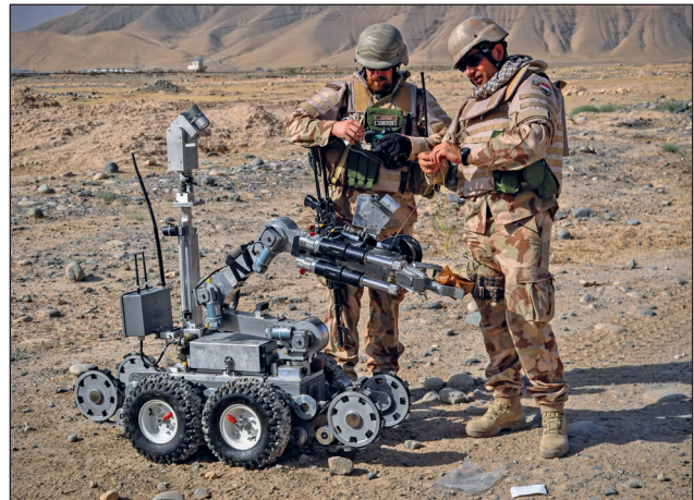
3. ábra. Az ANDROS F-6A típusú, távirányítású nehéz tűzserész robot az afganisztáni műveletekben is segítette a magyar tűzserészek munkáját (Fotó: HM Zrínyi Nonprofit Kft./honvedelem.hu)
