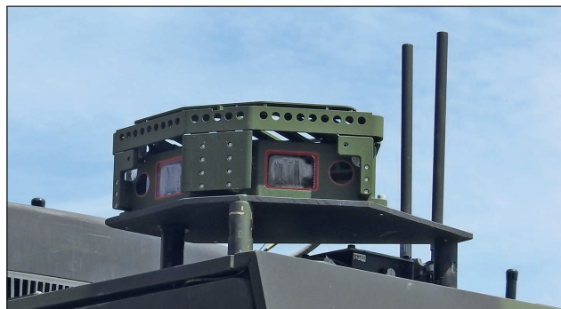
3. ábra. A Boxer gyalogsági harcjárműre szerelt SETAS optikai érzékelő doboza (Fotó: Ocskay István)
