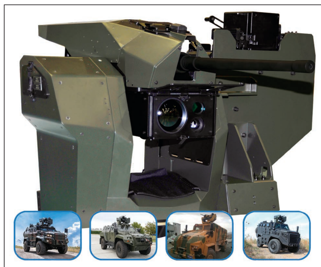
2. ábra. Az Aselsan SARP alapváltozata, 12,7 milliméteres nehéz géppuskával szerelve [2]
