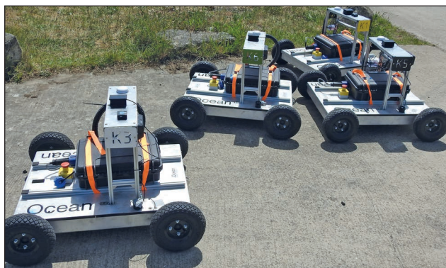
5. ábra. Az UGV-k csoportos feladatvégrehajtását modellezni hivatott egyszerűsített kis drónok (Fotó: Ocskay István)
