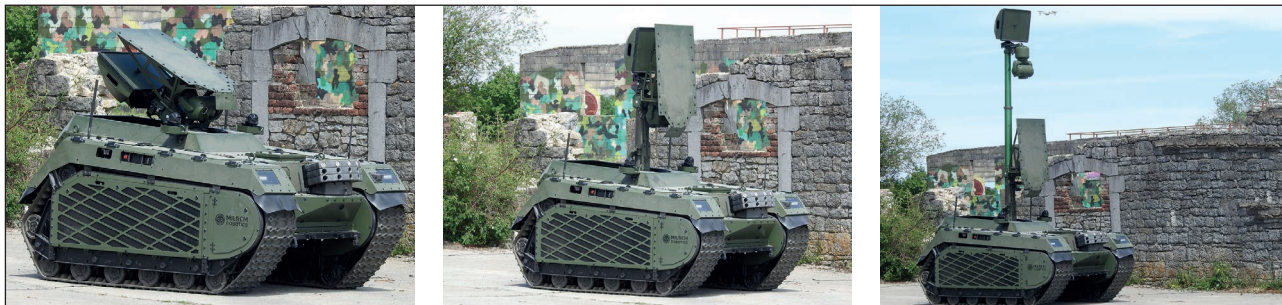
6. ábra. Felderítőradarral és optikai kamerákkal felszerelt, fedezékben álló THeMIS UGV (Fotók: Ocskay István)
