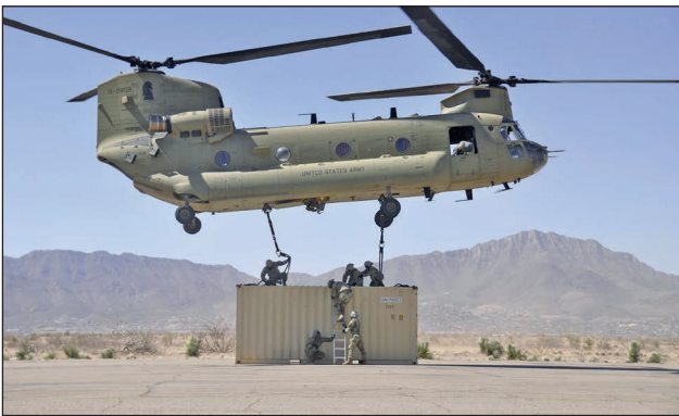
3. ábra. Logisztikája során egyetlen modern haderő sem nélkülözheti a szállítókonténereket, az amerikai hadsereg CH-47 Chinook helikoptere egy konténer külső függesztéssel történő emelésére készül (Forrás: defense.gov)
