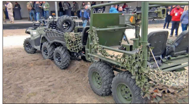
3. ábra. A lett különleges műveleti erők ROTAX 6x6 kerékképletű különleges rendeltetésű járműve a hozzá szerkesztett forgatható utánfutóval (Fotó: Ocskay István)
