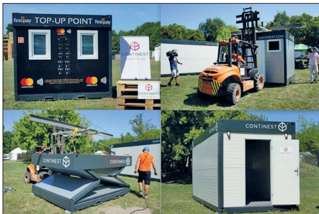
6. ábra. A Continest Technologies Zrt. innovációja, az összecsukható lakókonténer jelentős megtakarítást, gyors telepíthetőséget ígér (Forrás: Continest Technologies Zrt.)
