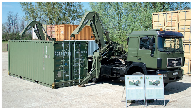
5. ábra. A Magyar Honvédség MAN típusú önrakodó konténerszállító tehergépkocsija. Az elmúlt évtizedekben az MH-ban szállító, műhely, labor, egészségügyi stb. merevvázias konténerek is rendszeresítésre kerültek (Forrás: HM Zrínyi Nonprofit Kft. / honvedelem.hu)
