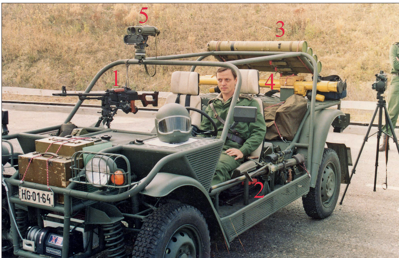
25. ábra. A KTJ 4 típusszámú gépjármű egy fegyverzetváltozatban. A terepjáró felszerelése: 1 – PKM géppuska, 2 – Gepárd M1 mesterlövész puska, 3 – Fagot indítókonténerek, 4 – Iglá1M légvédelmi rakéta, 5 – Lt7 (Forrás: Tóth József archívum)
