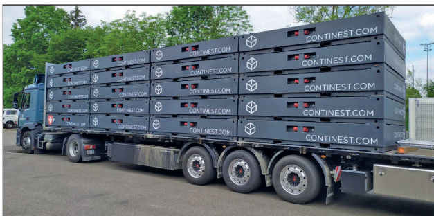
9. ábra. A telepítés 1. fázisa. Egy kamion félpótkocsin egyszerre 20 db CN 10-es összehajtott lakókonténer szállítható (Forrás: Continecst Technologies Zrt.)
