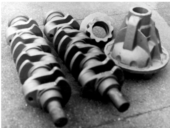
16. ábra Bentonitos keverékbe öntött alkatrészek
