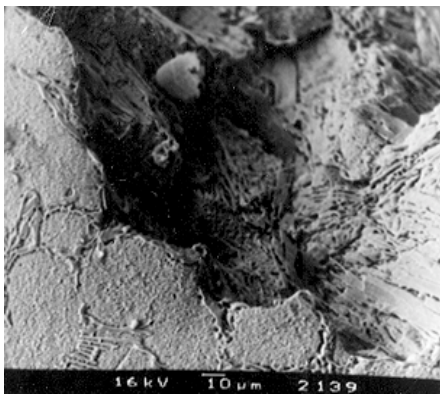
13. A felületről az anyag kiszakadása a kristályhatárok mentén történik, 1200x.
