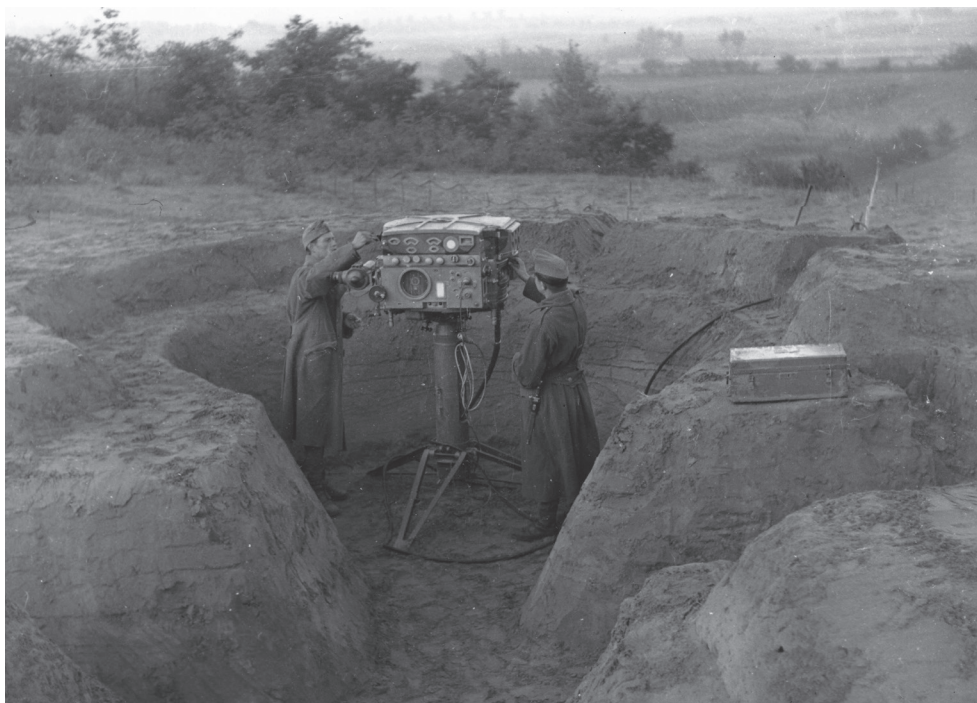
4. kép 34/38M löelemképző kiépített fedezékben (Köhler Ferenc felvétele)
