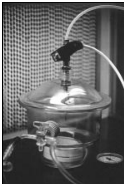
1. kép A házi készítésű génbelövő berendezés, amely bármely kutatóhelyen kevés műszerész segítséggel, néhány száz ezer forintból elkészíthető.
