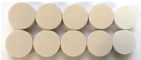
2. ábra A 450 °C, 575 °C, 775 °C, 870 °C és 1100 °C hőmérsékleten szinterelt minták
