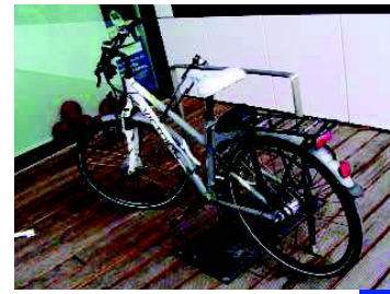
Az elektromos kerékpár indukciós töltőről kapja a tápfeszültséget
