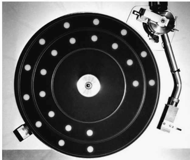
20. kép. Lemezjátszó: n = 45 RPM; \Delta t = 100 ms.
