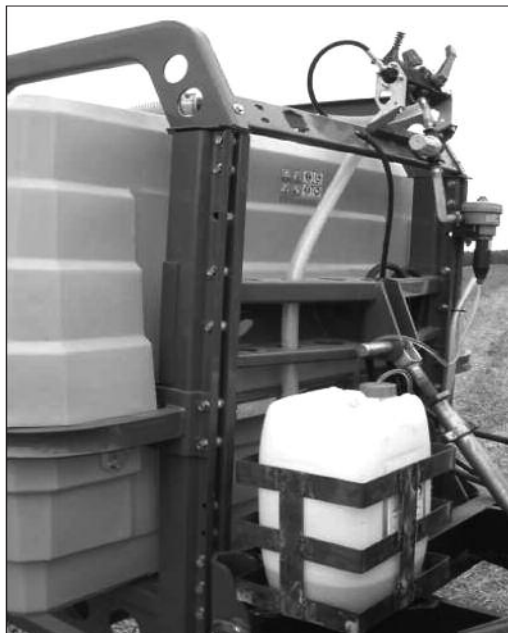
3. ábra. A herbicidadagoló berendezés
