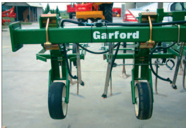
1. ábra. Sorvezérelt Garford típusú kultivátor sorpermetező szórófejekkel
