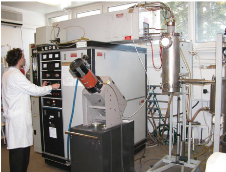
Rádiófrekvenciás (balról) és egyenáramú (jobbról) plazma berendezések működés közben
