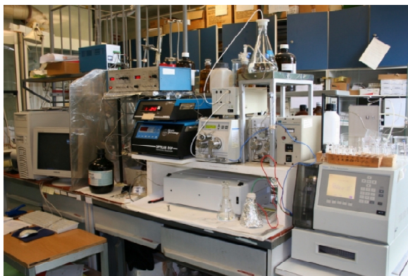
Multidetektoros gélpermeációs kromatográfás berendezés polimerek molekulatömegeloszlásának és átlag molekulatömegének meghatározására
