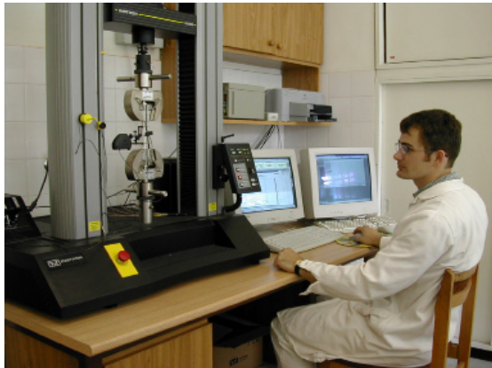
Polimerek mechanikai jellemzőinek vizsgálata
