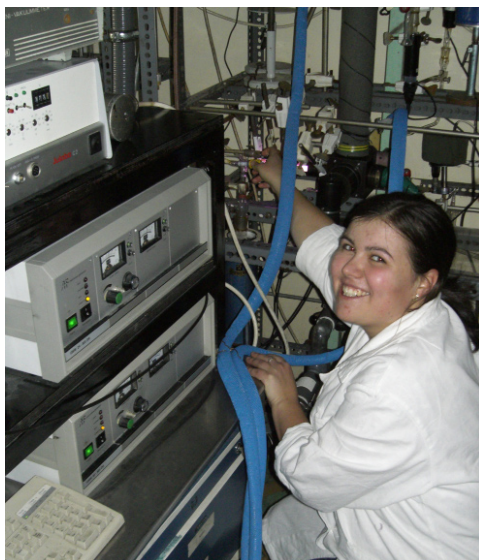
Reakciókinetikai vizsgálat gyorsáramlásos berendezéssel
