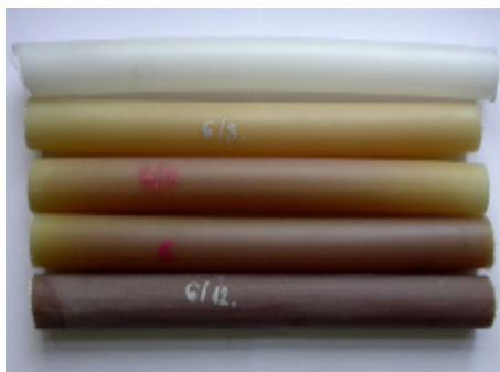
Az adalékok összetételének hatása a polietilén csövek elszíneződésére 80 °C-on hidrolitikus körülmények között
