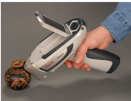
Mérés hordozható NITON röntgen fluoreszcencia spektrométerrel
