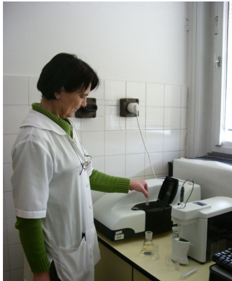
Fehérje és kitozán oldatok tulajdonságainak vizsgálata a Zetasizer Nano ZS műszerrel
