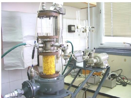
Mechanikus gejszárító inert töltettel
