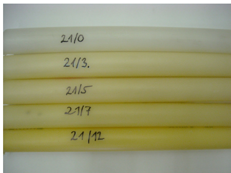
Az adalékok összetételének hatása a polietilén csövek elszíneződésére 80 °C-on hidrolitikus körülmények között
