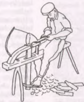
Zsindelyfaragás kézzel, a zsindelyvonásra alakított rugós faragószéken. Ploskucény (Szeret mente)
