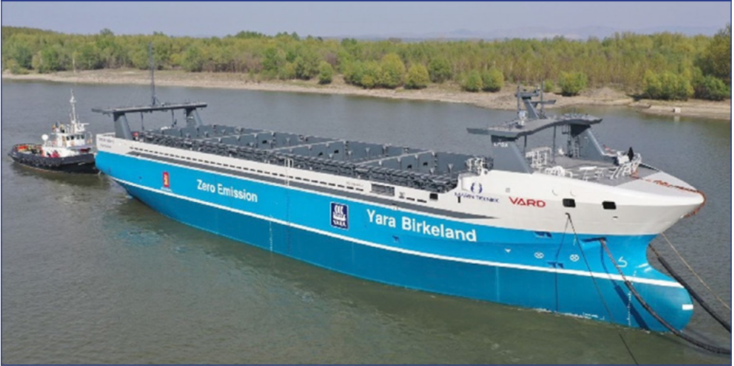
2. ábra: Yara Birkeland autonóm, elektromos konténerszállító ([14])
