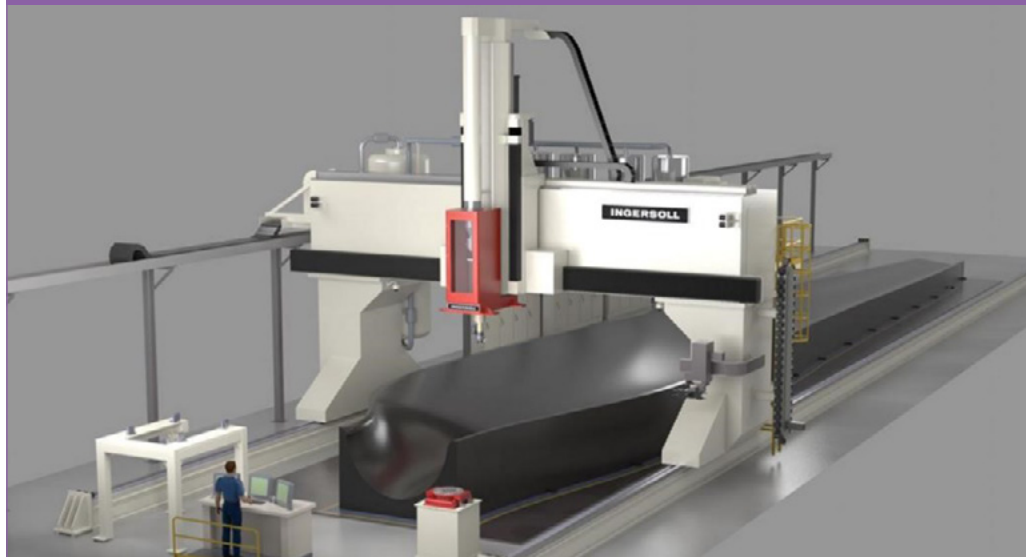
1. ábra: A világ legnagyobb, csak és kizárólag additív gyártási eljárással alkotott hajó nyomtatójának modellje [3]
