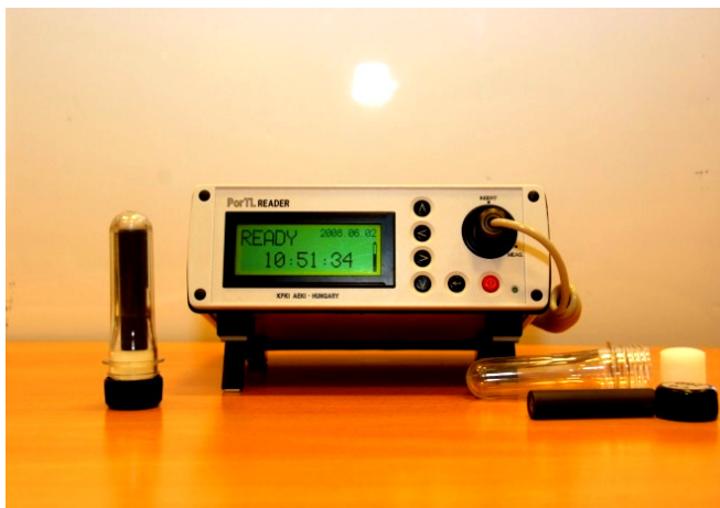
1. ábra. A PorTL rendszer: bal oldalon a védőtokba helyezett patron, középen a kiolvasó, jobb oldalon a patron és a védőtok látható.
