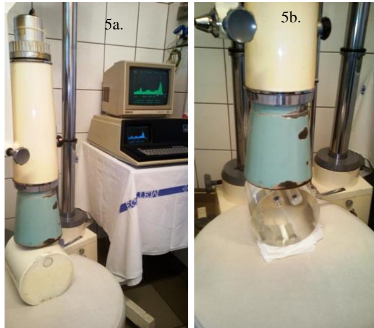
5. ábra: Az összemérésnél alkalmazott mérési geometria hagyományos pajzsmirigymérővel [saját forrás] Baloldali kép. az alkalmazott mérési geometria saját kalibrációs nyak fantommal, jobboldali kép CATHyMARA összemérés nyakfantom
