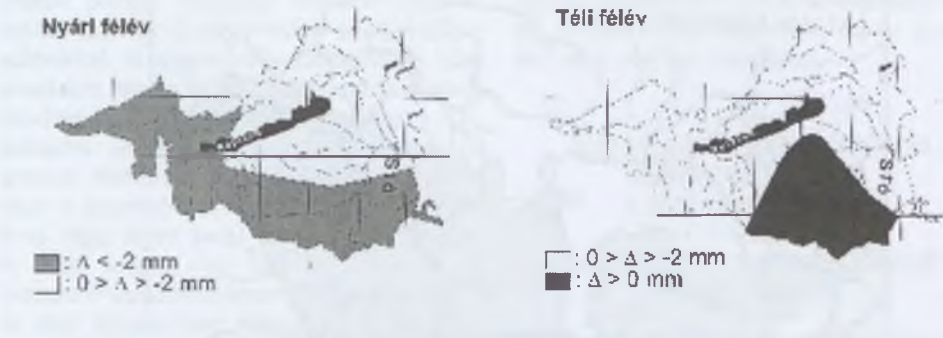
Sztochasztikus modeleredmények az esős napok becült napi csapadékanomáliáira 2 \times CO_2 klímaszcenárió esetén a Balaton–Sió vízgyűjtőterületre
