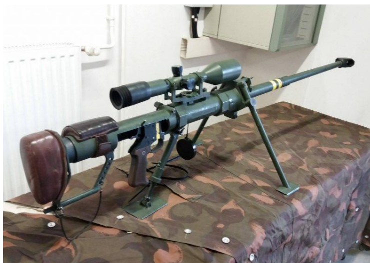
7. számú kép. Gepárd, a HTI által fejlesztett nehéz rombolópuska, amelyet a Magyar Honvédség mélységi felderítő, majd különleges műveleti csapatainál is rendszeresítettek
