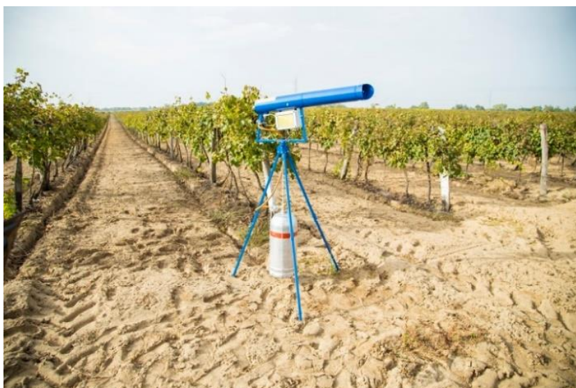
6. számú ábra. Szőlőtőkék mellé telepített NK5x sorozatból való vadriasztó gázágyú 25
