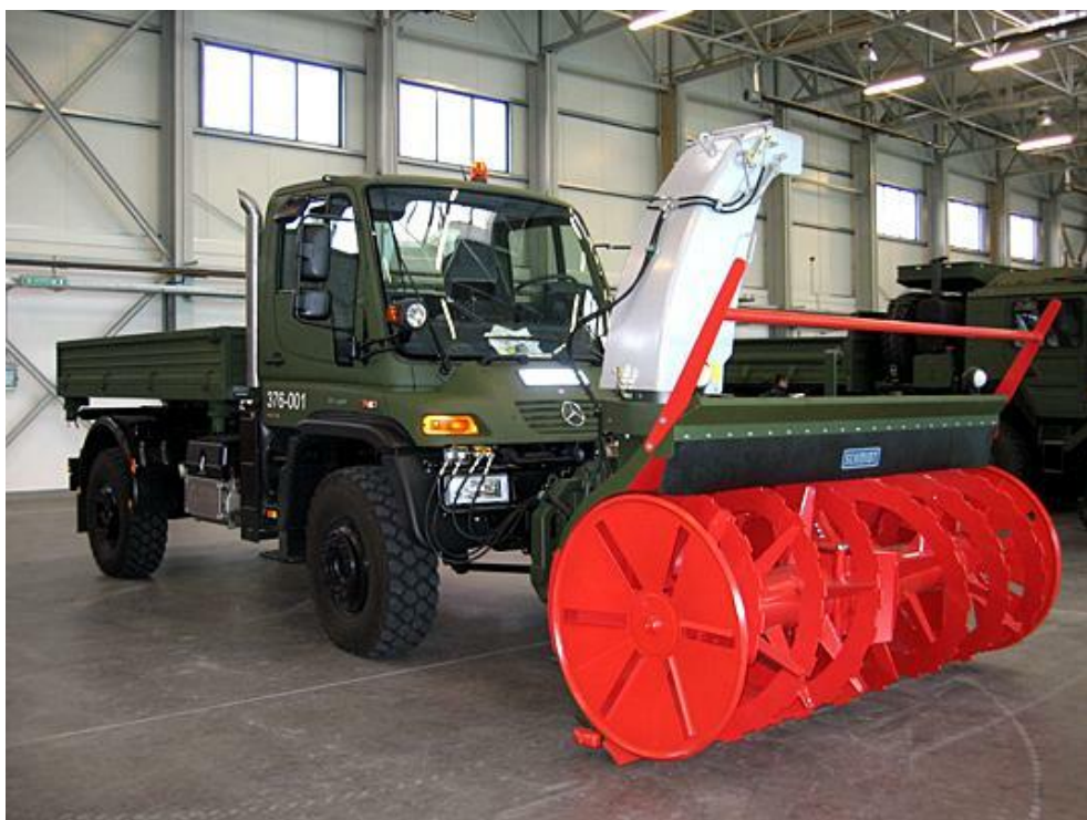
8. számú ábra. Unimog U500 típusú katonai terepjáró bázisjármű, Schmidt FS105-265 típusú hómaróval szerelve 24
