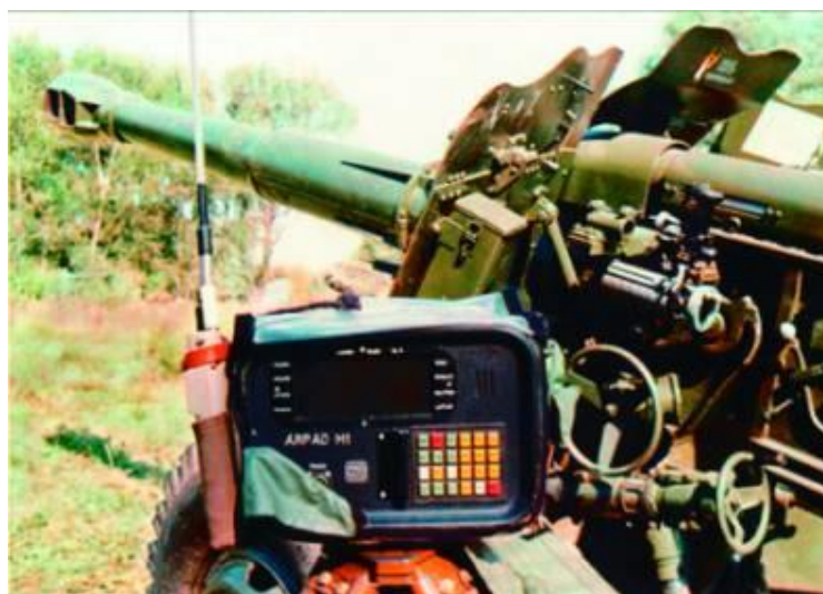
6. számú kép. A HTI által fejlesztett Árpád tűzvezetőrendszer, amely vontatott és önjáró tarack tűzvezetésére is alkalmas volt
