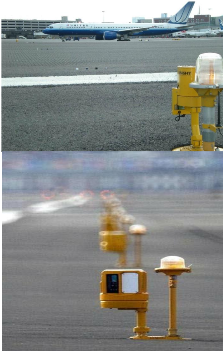
4. számú ábra. Automatizált FOD nagyfelbontású kamerarendszer és milliméteres hullámban dolgozó radar a pályaszegély-fények mellé telepítve. 17
