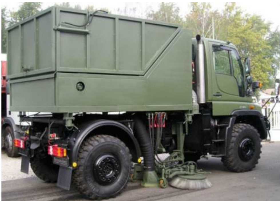
7. számú ábra. Unimog U400 típusú katonai terepjáró bázisjármű, City 4000 típusú seprőgép-konfigurációval szerelve 23
