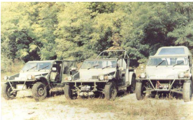
3. számú kép. A HTI és a Gépfet Kft. által fejlesztett Szöcske könnyűjármű-család. Hat prototípus készült, az elkészült járműveket alkalmazásba vette a Magyar Honvédség
