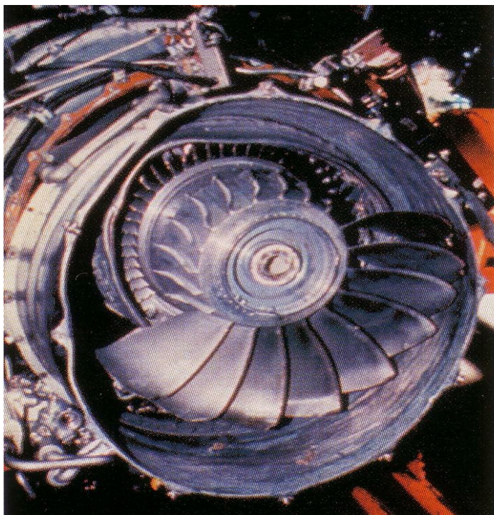
1. számú ábra. Repülőgép hajtóműve egy madárral való ütközés után 10
